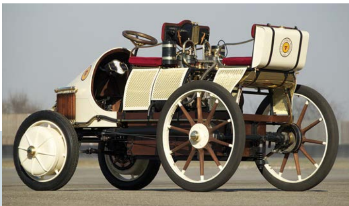
Lohner-Porsche met elektromotor in de wielnaaf.
